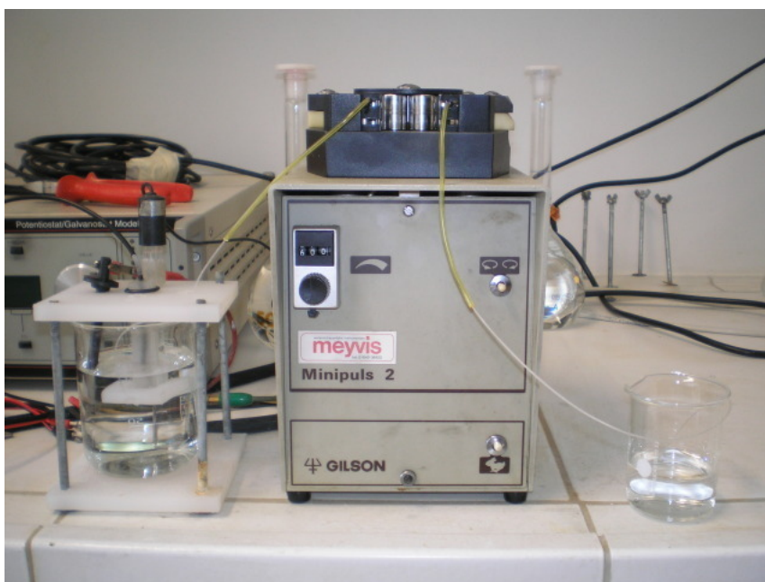
Σχήμα 4.6: Περισταλτική αντλία Gilson Minipuls 2 συνδεδεμένη με κελί τριών ηλεκτροδίων.
