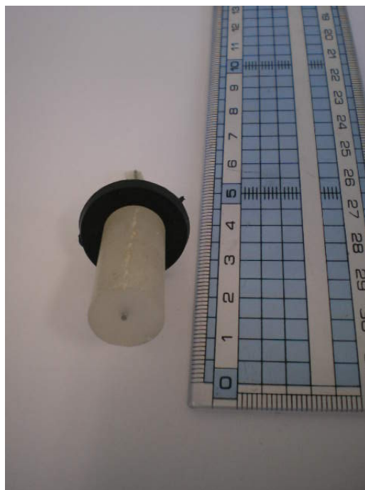
Σχήμα 4.2: Μονό οριζόντιο ηλεκτρόδιο εργασίας δίσκου διαμέτρου 1 mm.
